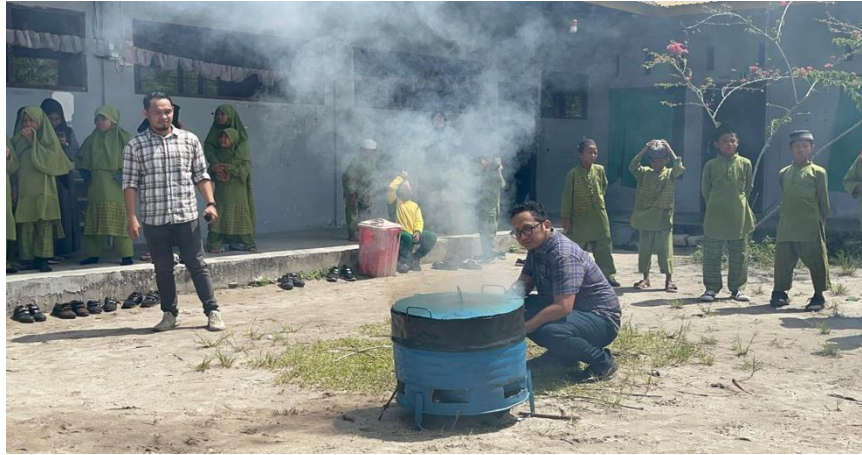
Gambar 4. Uji Coba Pembakaran Pada Rocket Stove Sumber: Dokumentasi Tim Pengabdi(2025)
